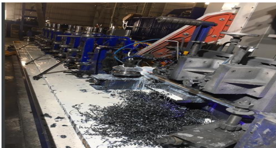
Hình 1.9. Công đoạn bào đường hàn
