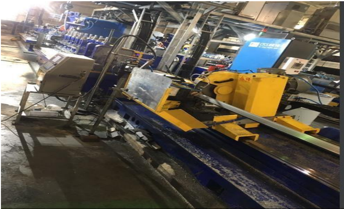
Hình 1.10. Hình ảnh Công đoạn cắt tự động
