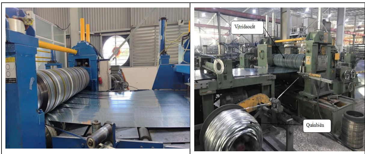
Hình 1.3. Hình ảnh công đoạn cắt, vị trí cắt tôn và quấn phế (dây biên)
