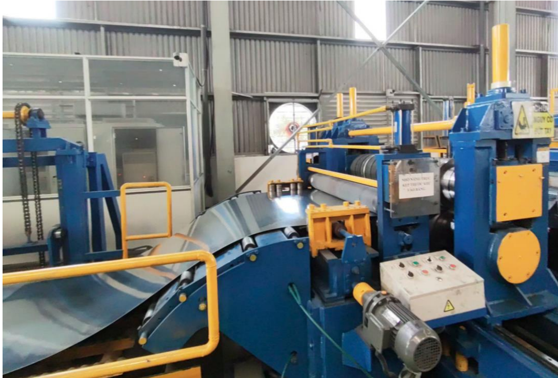
Hình 1.2. Hình ảnh minh họa công đoạn xả cuộn
